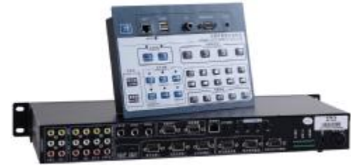
面板表面尺寸219×143mm， 面板开孔尺寸202×139mm，
