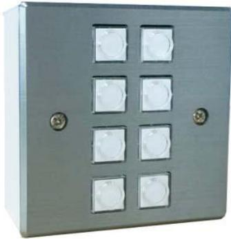
面板上为 8 个输入按键, 按键、带指示灯一体化设计。系统安装完毕之后, 可通过软件编程定义按键指令代码, 执行各种逻辑指令。编程完毕之后, 直接通过按键就可以控制连接至中控主机的外设, 执行相应的逻辑指令。按下按键则通过 NET 传输控制代码给中控主机, 通过中控主机控制相应的外设。
